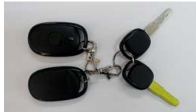
Para o acionamento do alarme basta apertar o botão com o **desenho de um cadeado fechado**, no controle. Para destravar o alarme basta pressionar o botão com o **desenho de um cadeado aberto**, no controle.
